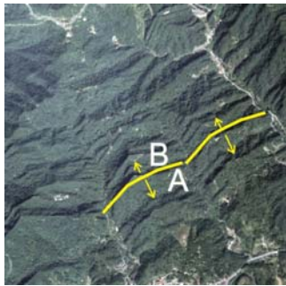
(e) 順向坡，A 為順向坡面，B 為逆向坡面。
