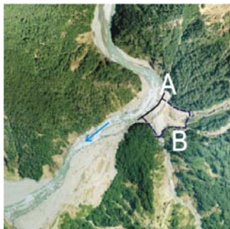
(g) 河岸侵蝕，A 為河道攻擊坡位置，B 為河道旁之崩塌地。
