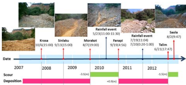
圖 10 一號坑歷年土石流事件河道沖淤變化圖
