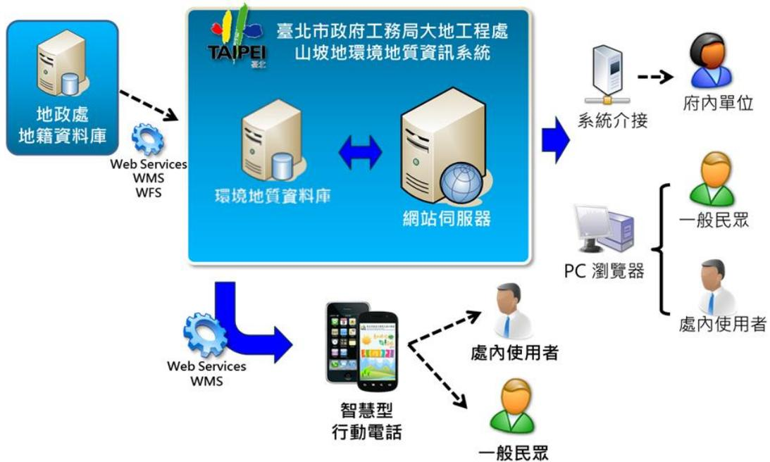
圖2 山坡地環境地質資訊系統架構示意圖
