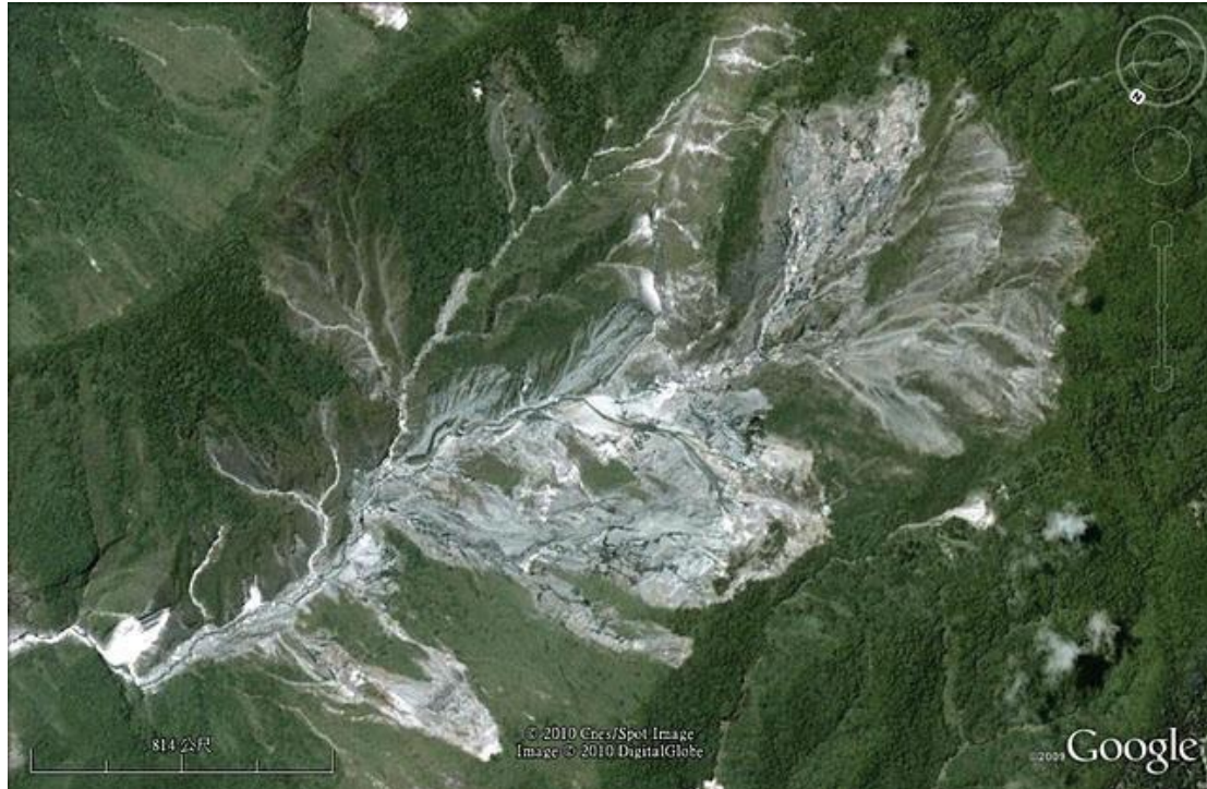
圖八 土石流的發源地；流水沖刷是土石材料最主要的生產者及供應者。影像中可見岩盤非常破碎，且被流水嚴重沖刷(Google Earth 影像)
